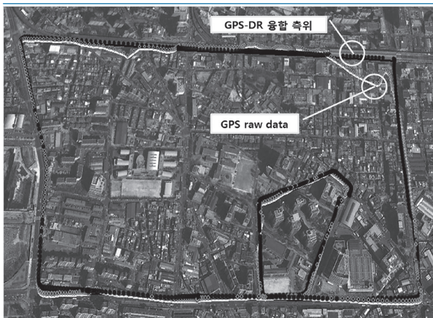
그림 10. 차량용 센서융합 측위 시스템 측정결과
