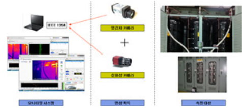
그림 5. 열화상을 이용한 전력설비 평가 시스템 구성도.
