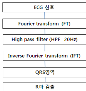
그림 5. 푸리에 변환을 이용한 R-파 검출 순서도 Fig. 5. R-wave detection flow chart using Fourier Transform
