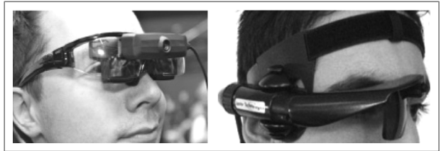
출처: http://en.wikipedia.org/wiki/Head-mounted_display 그림 1 착용 AR 디스플레이기반 곡면거울 방식
