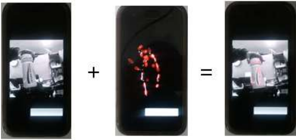
그림 12. 원본 이미지와 특징점을 검출한 이미지를 정합한 영상. Fig. 12. Image combination of original image and feature-detected image.
