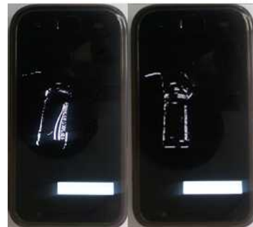
그림 10. 차 영상으로부터 이진화 영상 표현. Fig. 10. The binary image representation from difference image.
