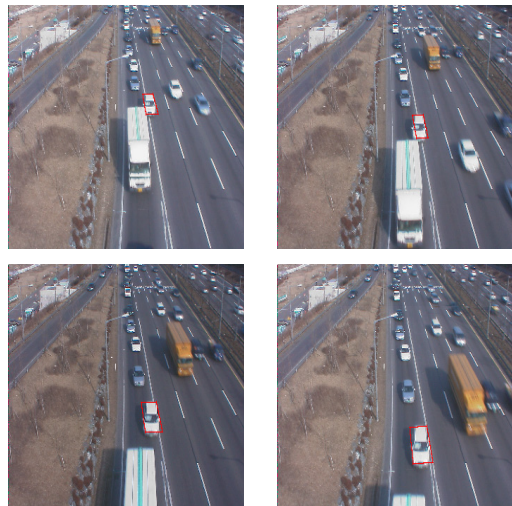
<그림 1> 끼어들기 위반차량 행태 <Fig. 1> Intruding violation vehicles behavior
