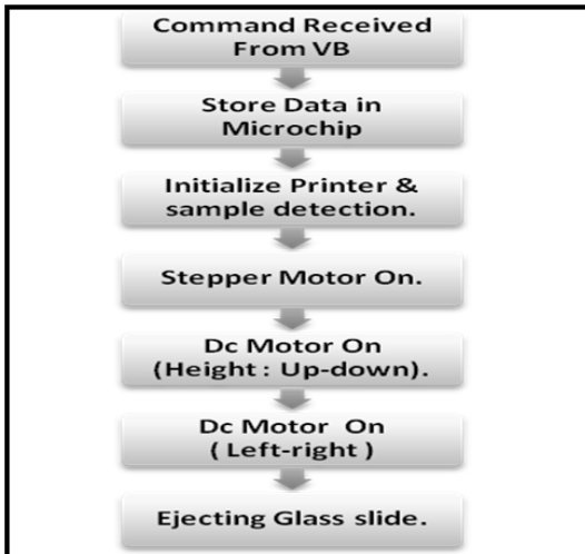
그림 12. 엡손프린터 프린팅 과정 Fig. 12 Epson printer printing process
