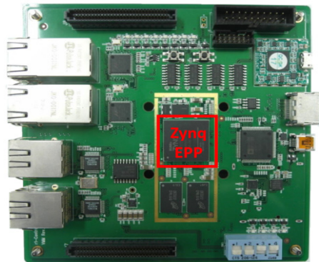
그림 6. 모터 제어기로 사용된 m.Controller v1.0 메인 제어기
