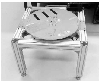
그림 5. 제작된 회전 테이블 Fig. 5. Manufactured rate table
