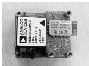
그림 6. ADIS16405 관성센서 모듈 Fig. 6. ADIS16405 inertial sensor module
