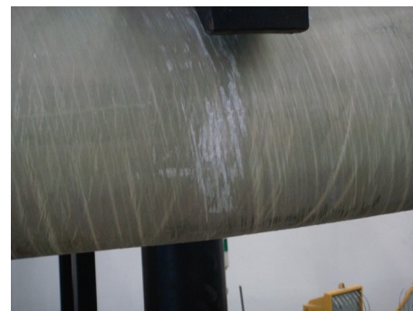
Fig. 8 Failure Mode of HCFFT Specimens under Flexure (Kang, 2012)
