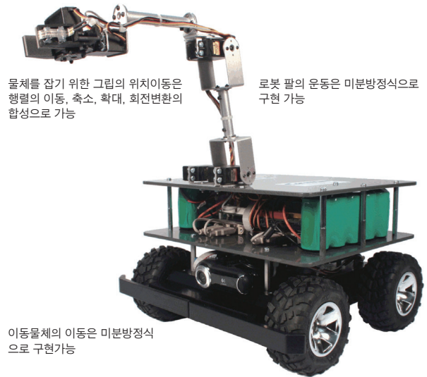
그림 5. 팔을 가진 이동 로봇과 수학 Fig 5. Motion equations in a moving robot with an arm.
