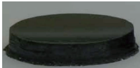
Fig. 8. 용액성장법으로 얻은 NSSMC사의 직경 3.75인치급 4H-SiC 단결정. 16)
