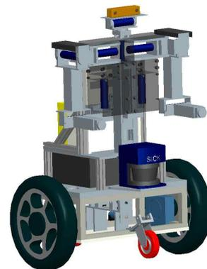
그림 1. 두 팔 달린 서비스 로봇의 개념도.
