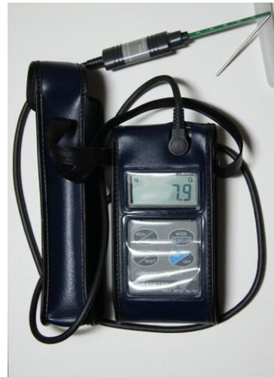
Fig. 2. Tesla meter(KANETEC : TM-701)
