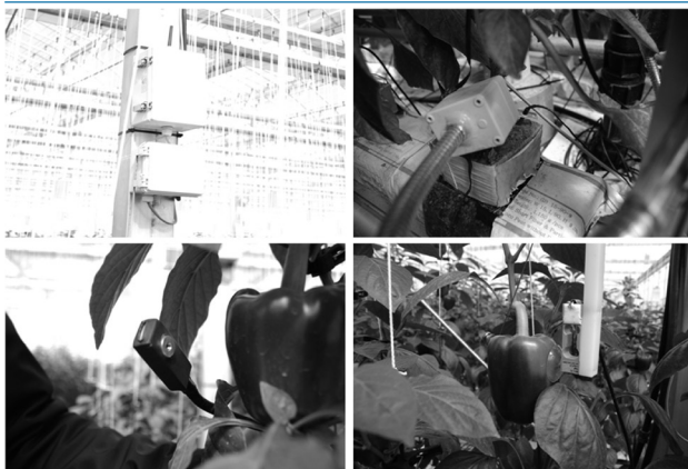
그림 8. 온실 환경 및 성장 모니터링을 위한 센서노드
