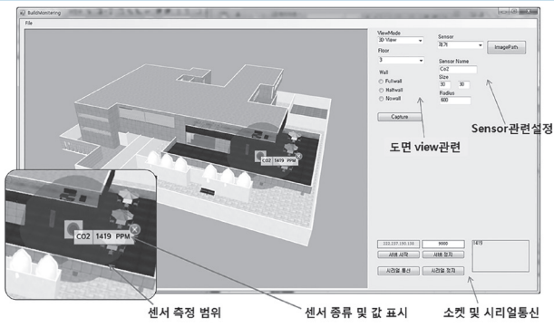
그림 5. BIM 3차원 도면 기반 센서 관리 시스템
