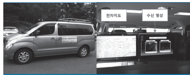
그림 10. AT-DMB 수신성능 측정 차량 및 내부 측정화면
