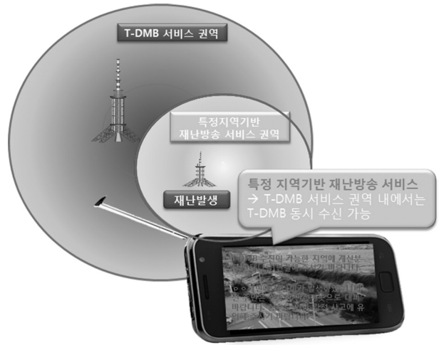
그림 10. 동일채널 중계기를 활용한 지역기반 자동인지 T-DMB 재난방송서비스
