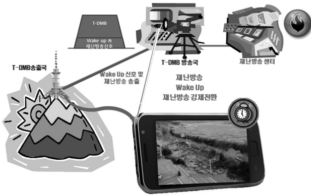
그림 9. 자동인지 T-DMB 재난방송 서비스 개념도
