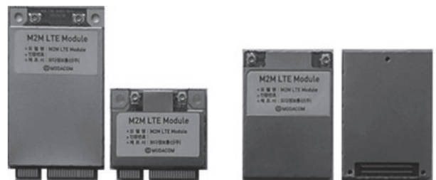
LTE-FDD, LTE-TDD (Mini-PCIe, B2B)
