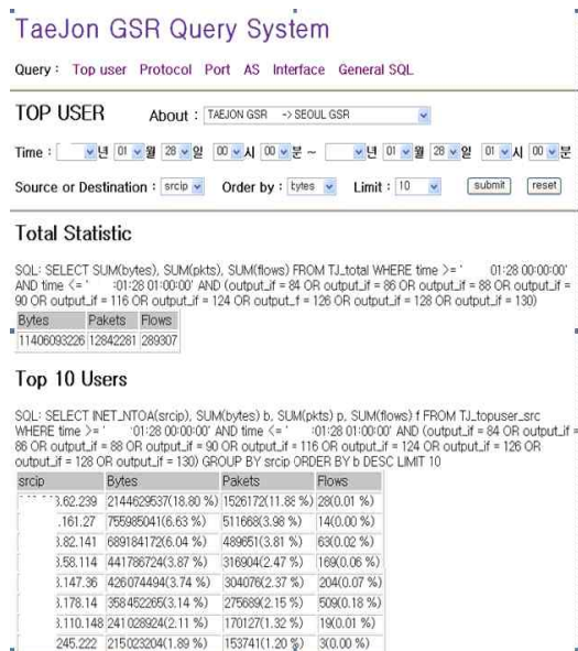
그림 10. 질의 결과: Top 10 사용자들 출력 화면 Fig. 10. FlowMap query results: Top 10 users
