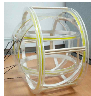
그림 7. 제안한 방법으로 설계된 코일 Fig. 7. Designed and constructed coil by proposed method.
