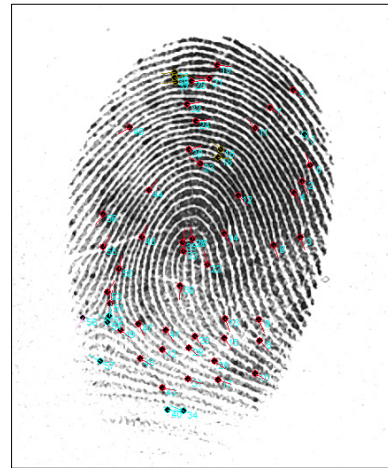
그림 10. 평면지문의 특징점 추출 결과 영상 Fig. 10. Plain fingerprint minutiae result image.
