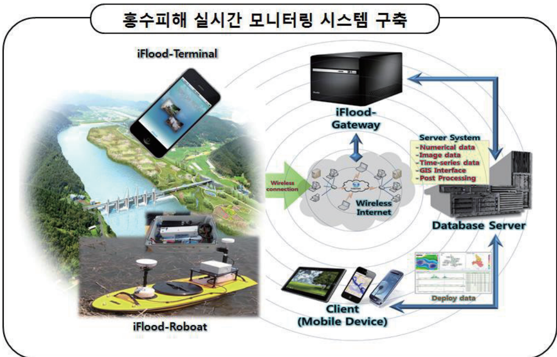
그림 5. 홍수피해 실시간 모니터링 시스템 개요도
