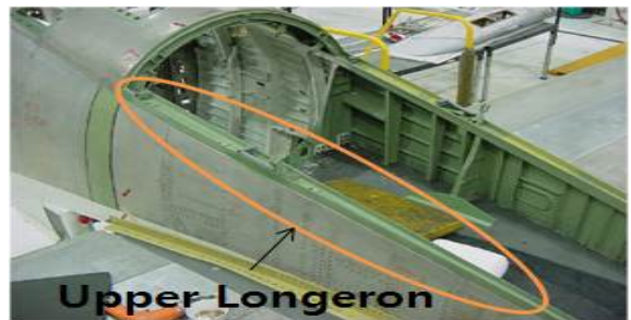
Fig. 1. Nacelle Upper Longeron in P-3CK
