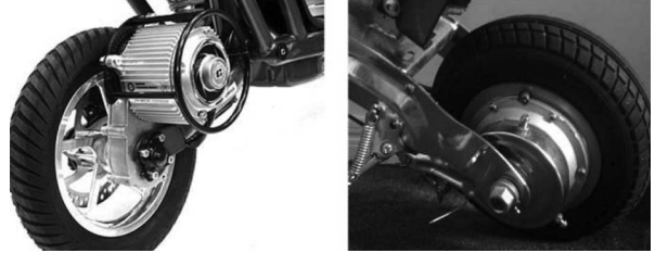
그림8. 직결모터(좌) 및 BLDC 허브모터(우)
