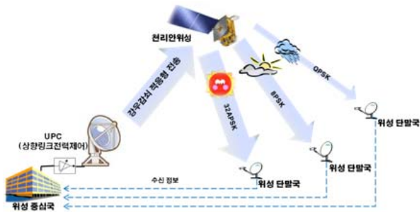
그림 2. DVB-S2 ACM 기술을 적용한 위성통신 시스템 개념도
