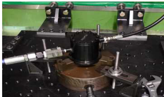
그림 7 상온 파열 시험
