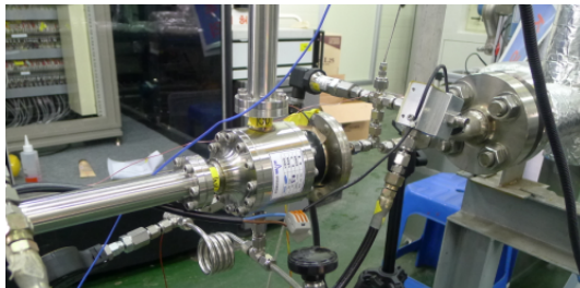
그림 5 상온 고주기 피로 수명 시험
