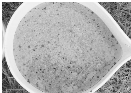
▲ 세척제를 사용하여 음수 라인 내의 바이오필름을 제거할 때 나온 물. 흙탕물과 같은 매우 지지분한 물이 나오고 부유물이 떠 있음, 이러한 부유물이 음수라인 안에서 음수량을 줄여줄게 하고 세균의 번식처가 된다.
