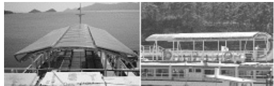
Fig. 15 태양전지 설치 완공 모습
