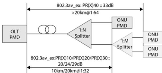
(그림 7) Extended EPON PMD 구조도[14]
