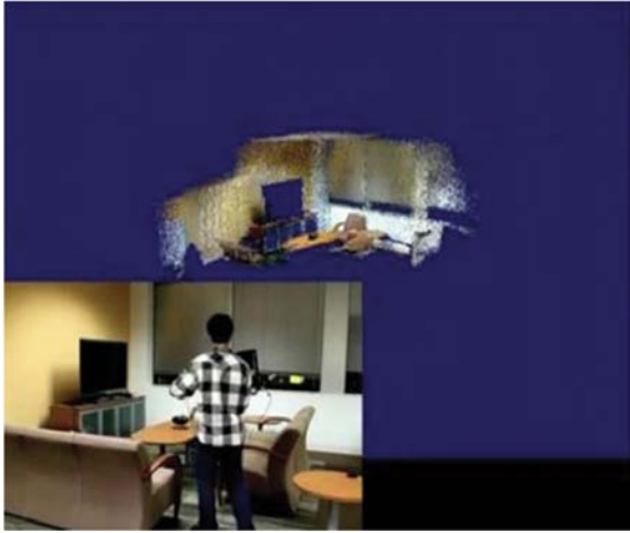
(그림 13) RGB-D Mapping에 의해 생성된 실시간 3D Point Cloud
