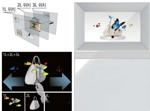
(그림 25) 3레이어 기반 시험용 콘텐츠 및 키오스크형 운용장치
