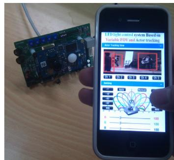
그림 5. 스마트폰을 이용한 LED조명 FOV 및 RGB제어
