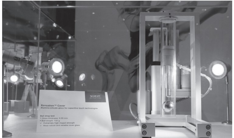
▶132g의 쇠구슬을 계속해서 0.55mm의 박막 쇼트 센세이션 커버에 낙하시키는 쇠구 낙하 테스트의 시연 모습.
