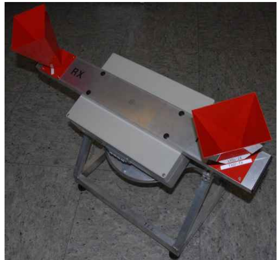
그림 3. 능동형 트랜스폰더 (Active Transponder) [1]
