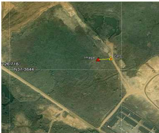
그림 9. SAR 영상 점표적 응답과 GPS 측정위치 차이 (2012. 02. 17)
