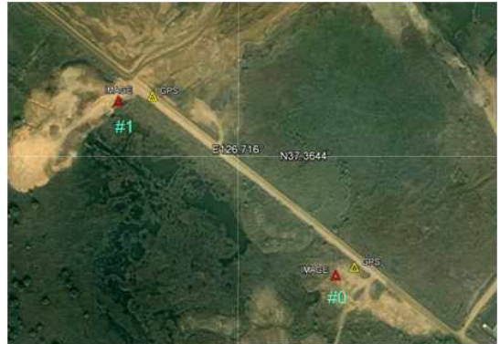
그림 11. SAR 영상 점표적 응답과 GPS 측정위치 차이 (2012. 04. 06)
