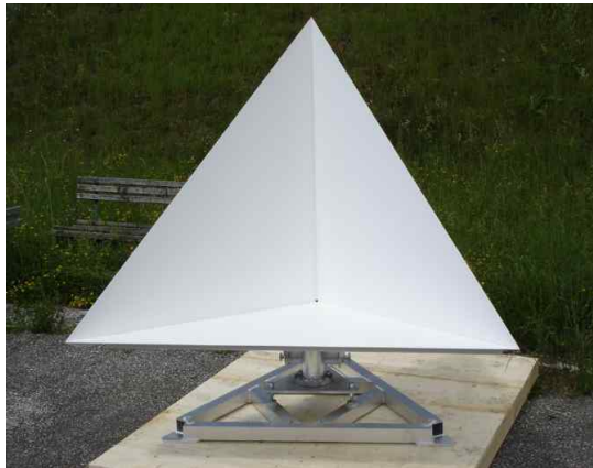
그림 2. 삼면각 레이더 반사판 (Trihedral Corner Reflector) [1]
