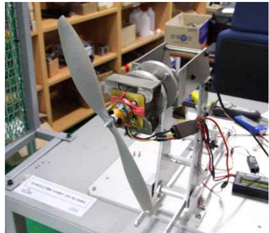
그림 7. 모터/프로펠러 추력시험 장치
