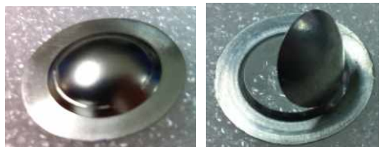
그림 12 원주형 스코어 파열판 (좌 : Ni 01t 파열전, 우 : Al 0.4t 공압 파열후)
