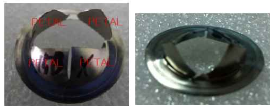
그림 4 최대 유량 시험 이후 변형 형상 (좌우 : 동일 시험)
