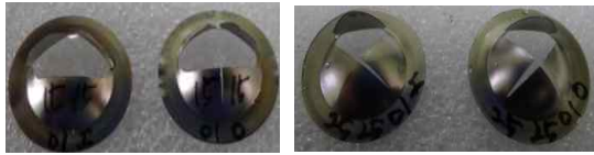
그림 9 시험 후 변형 형상(좌 : 0.1t, 우 : 0.15t)
