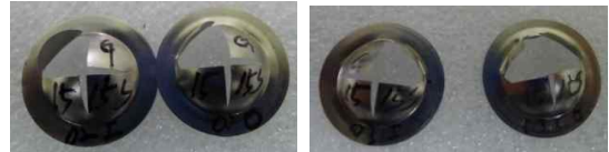
그림 11 시험 후 변형 형상 (밸브 연결 점화기, 좌 : 유량 3.13, 우 : 유량 3.28)
