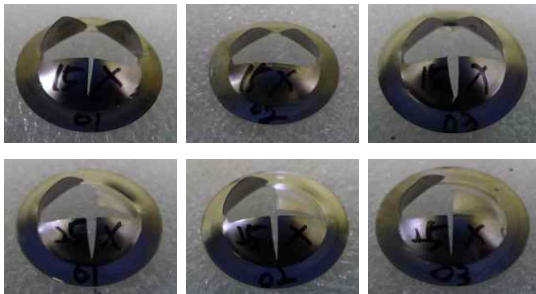
그림 7 시험 후 변형 형상 (위 : 0.1t, 아래 : 0.15t)
