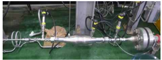
그림 8 양단 방사형 스코어 파열판 점화기 유량계수 시험
