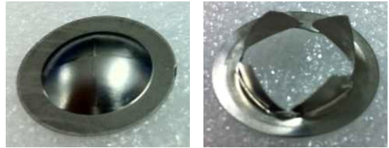
그림 2 방사형 스코어 파열판 (좌:파열전, 우:공압 파열 후)
