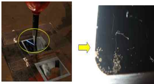
그림7 SSM 정전기 방전 시험 및 시편
