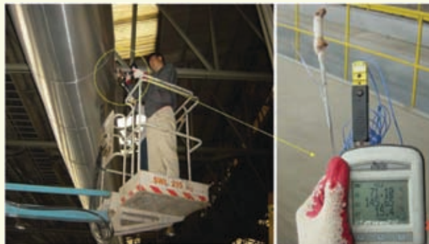
〈그림 3〉 건조로 각부의 상태량 측정과정
