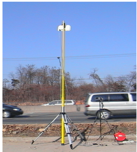
그림 7 실제 도로상에서의 차량 데이터 수집 Fig. 7 Collection of vehicle data on a real road.
