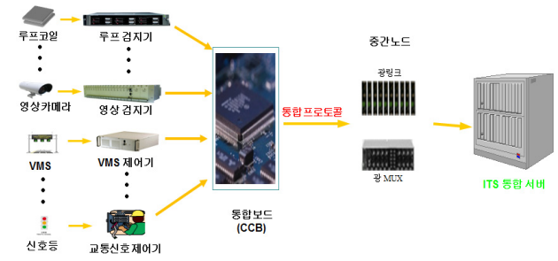
그림 3 통합 프로토콜 기능을 갖는 현장장비의 구성 개념 Fig. 3 Concept for configuration of the field equipments with the function of unified protocol.
