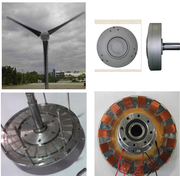
그림 10 AFPM 발전기 설계 및 제작도 Fig. 10 Manufacturing and installation of AFPM machine
