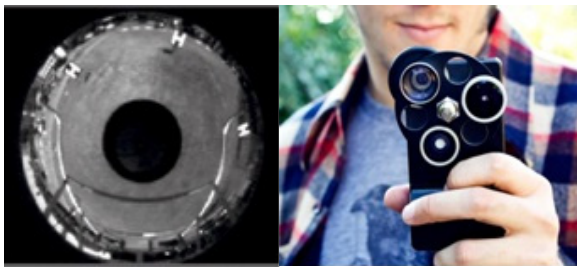
그림 1. 헬기에서 촬영한 어안렌즈 영상과 어안렌즈를 사용한 스마트폰 장착 카메라 기기 Fig. 1. An image from a helicopter by fish-eye lens and a device equipped smart phone with fish-eye lens
