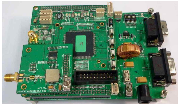
그림 2. (주)텔에이스에서 개발한 GPS 단일칩 수신기 T1 칩셋을 탑재한 GPS 수신기 및 데이터 전송기.
