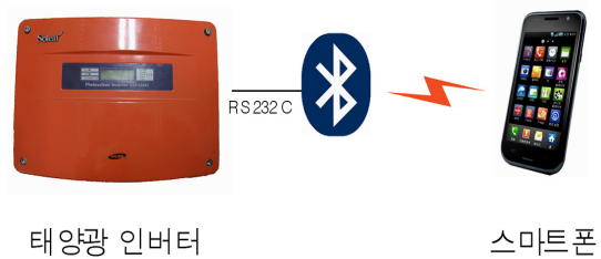
그림 1. 인버터의 블루투스 통신시스템 구성도 Fig. 1 Bluetooth communication system configuration of Power Condition System
