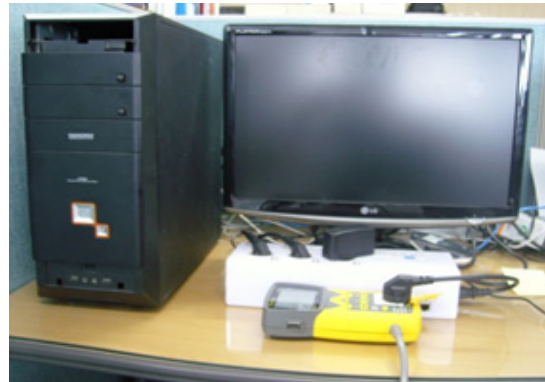
그림 7. 대기전력 측정 Fig. 7 Measurement of Standby Power
