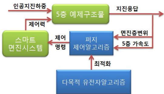
그림 15. 다목적 유전자알고리즘을 이용한 퍼지제어의 최적화 개념도
