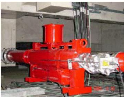
그림 2. 스마트 면진시스템을 구성하는 400kN MR 감쇠기
