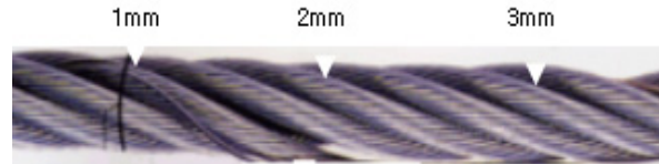
그림 7 와이어로프 결함 설정 Fig. 7 Shape of wire rope flaws
