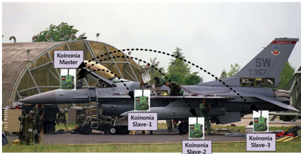
그림 8 F-16K 전투기의 WFAN 구성도 Fig. 8 WFAN configuration for F-16K fighter
