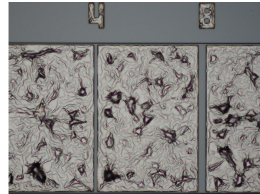
그림 2 옴릭 콘택 저항을 측정하기 위한 제작된 TLM 패턴의 현미경 사진
