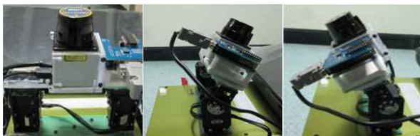
그림 2. 서보모터를 이용한 LRF 기울임 각도 조절 Fig. 2. Servo motor with adjustable tilt angle LRF.
